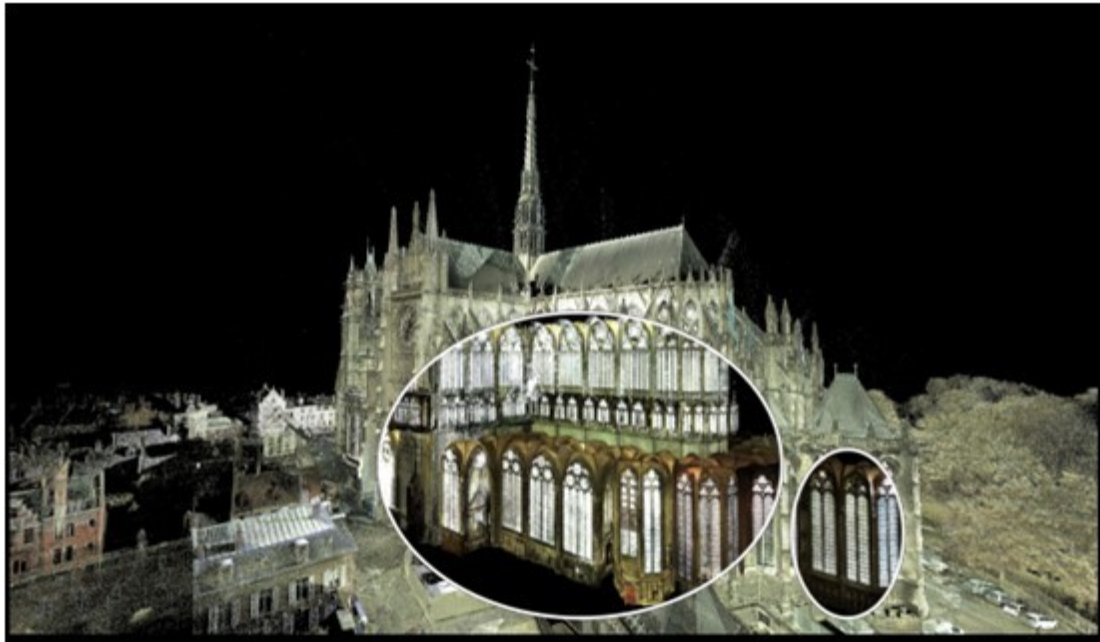
Figure 1 : Nuage de points 3D de la cathédrale d'Amiens. Cet extrait fait apparaître l'extérieur tel qu'on peut l'obtenir avec un appareil photographique et l'intérieur (à travers les bulles), que seul le modèle 3D permet de visualiser facilement.
